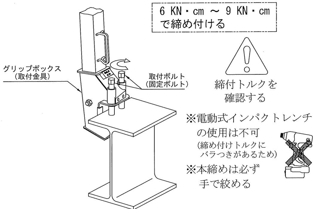
両方の取付ボルト (固定ボルト) を、トルクレンチを使用して6KN・cm以上 9KN・cm以内で締めてください。
