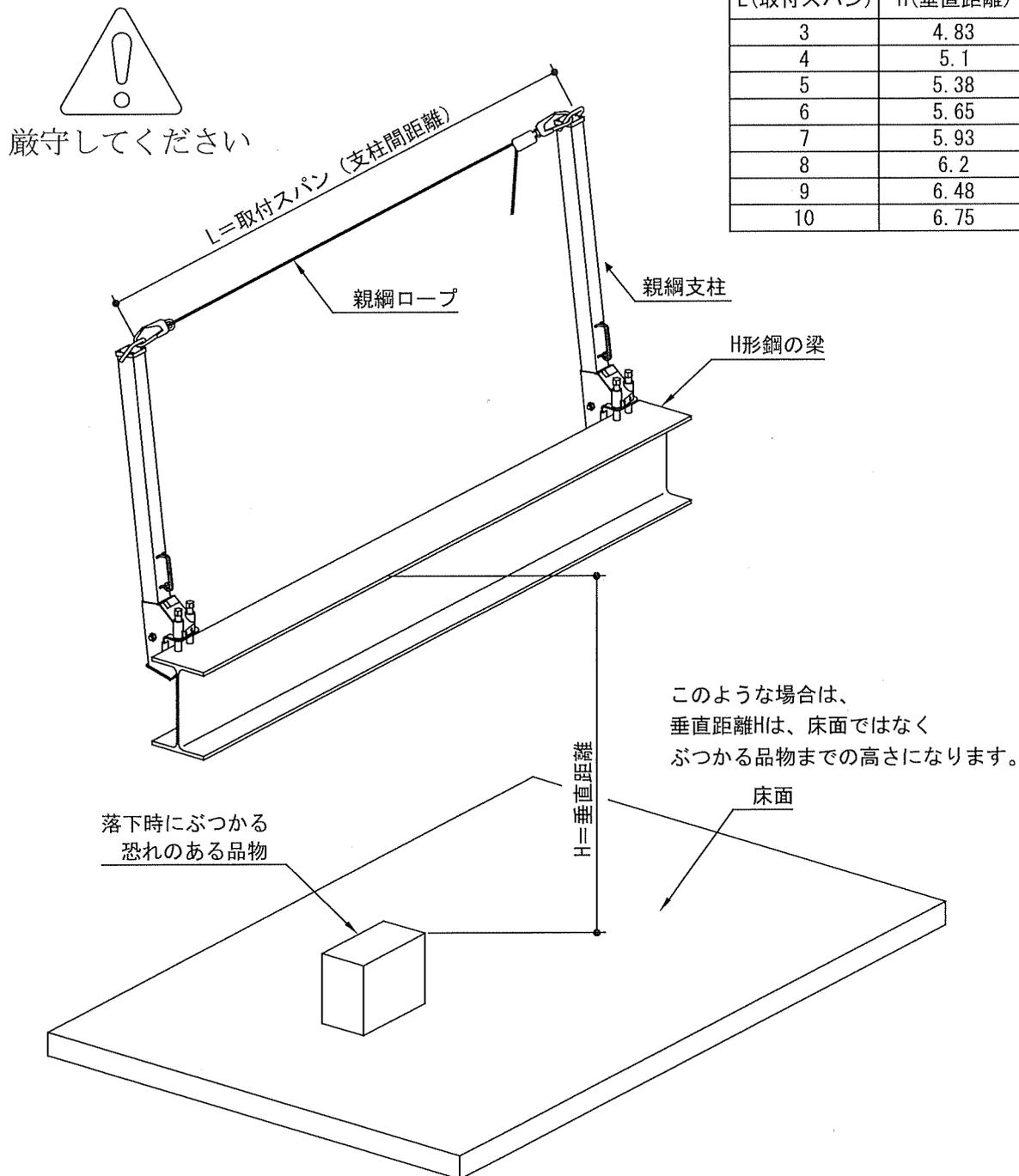
※垂直距離が算出した値を確保できない場合は、「墜落制止用器具の安全な仕様に関するガイドライン」(厚生労働省 2018/06/22 公表)において、水平親綱を低い位置に設置する場合について記述された「作業場所の構造上、低い位置に親綱を設置する場合には、短いランヤード又はロック機能付き巻取り式ランヤードを用いる等、落下距離を小さくする措置を講じること。」に準じること。
