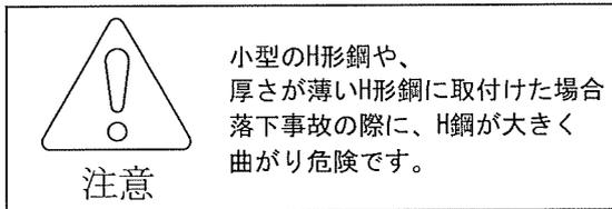
小型のH形鋼や、厚さが薄いH形鋼に取付けた場合落下事故の際に、H鋼が大きく曲がり危険です。
