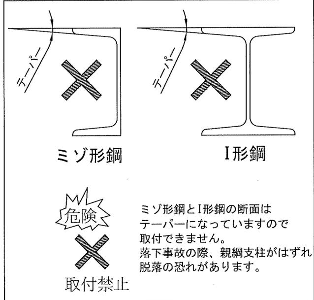
ミゾ形鋼とI形鋼の断面はテーパになっていますので取付できません。落下事故の際、親綱支柱がはずれ脱落の恐れがあります。
